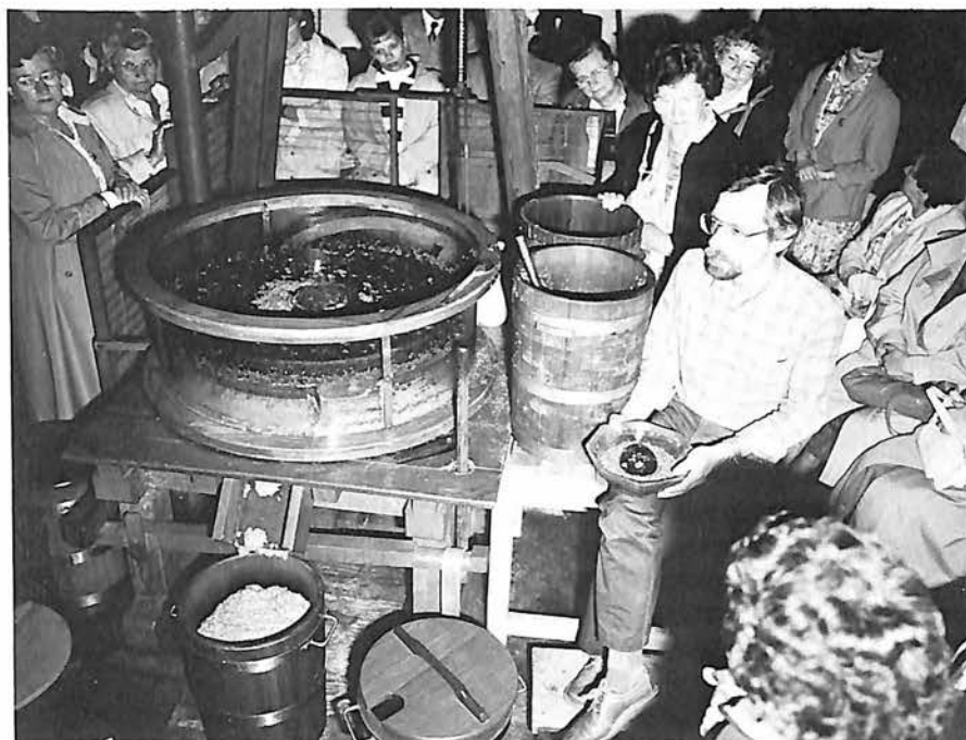
Bezoekers aan het Doesburgse mosterdmuseum wordt getoond hoe vroeger, met een kogel in de bak met mosterdzaad, het pittige produkt werd gemaakt.
